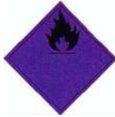
Danger émanation de gaz inflammable au contact de l'eau
