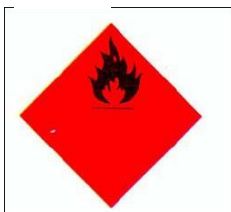
Danger de feu (liquide ou gaz)
